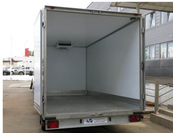
Прицеп-фургон рефрижераторный производства ЗАО «ИСТОК», предназначен для транспортировки грузов со специальными температурными условиями. Корпус фургона изотермический, выполнен по сэндвич-технологиям.
