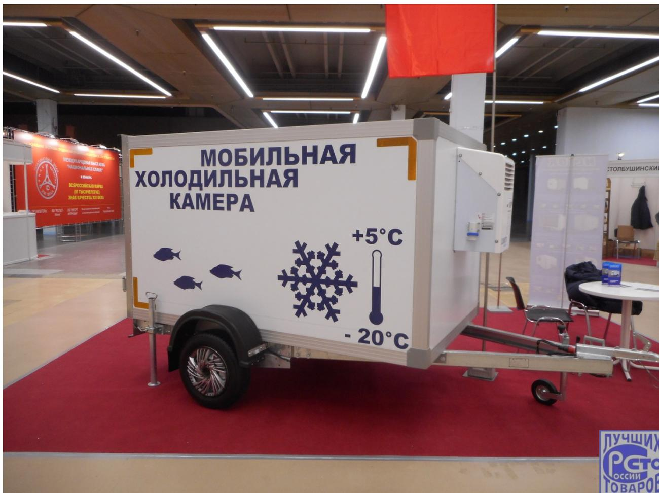
Мобильная холодильная камера представляет из себя легковой прицеп, на который установлен изотермический сэндвич фургон с холодильным оборудованием, работающим от напряжения 220 Вт.
