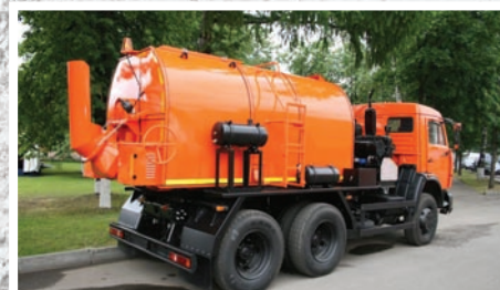
Многоцелевой термос-миксер БЦМ-257. Предназначен для ямочного и капитального ремонта дорожных асфальтобетонных покрытий, гидроизоляции мостов и устройства покрытий литым асфальтом. Имеется возможность приготовления асфальтобетонной смеси в полевых условиях, битумополимерных композиций, мастик, эмульсий, паст. Машины оборудованы лопастной мешалкой.
